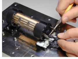
発生器のネジを外します。
