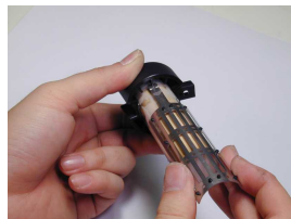
電極板を外します。
